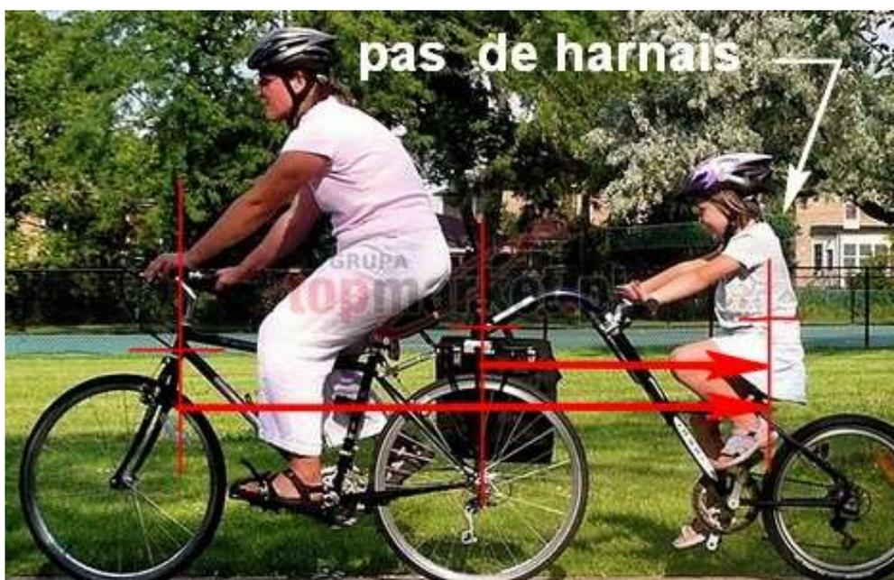
En cas de choc frontal de l'attelage légèrement désaxé, il y a rotation du semi-vélo tracté au niveau du tube de direction du vélo tractant, soit au niveau du point de fixation du dispositif d'accrochage et éjection violente de l'enfant contre tous les obstacles fixes environnants : véhicules en stationnement, mobilier urbain, bordure de trottoir, murs, etc. !
