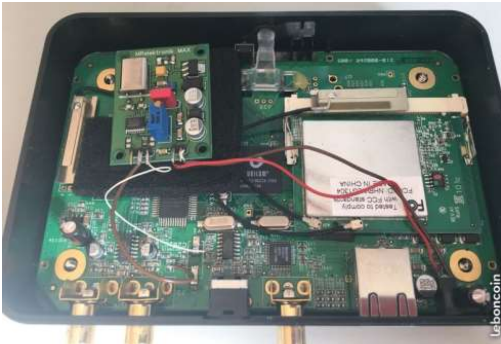
Implantation d'une nouvelle horloge maître sur le récepteur de J-R.
