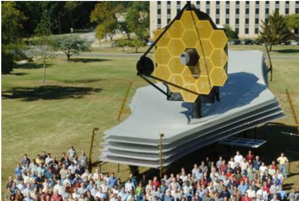
JWST et son pare-soleil d'une superficie égale à celle d'un terrain de tennis. Maquette échelle 1/1.
